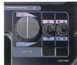
ポンプバランス
